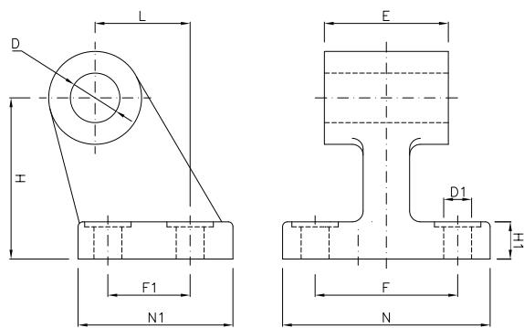
**NOTA:** - Material em Aço Micro Fundido, altíssima resistência.
