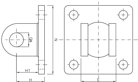
**NOTA:** - Material em partes de **Aço Soldada**, modelo **Econômico**.
