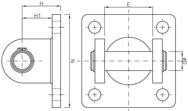
**NOTA:** - Material em partes de Aço Soldada, modelo Econômico.
